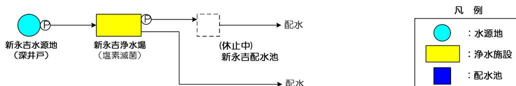
図-1.3 指宿地域の水道施設フロー図
