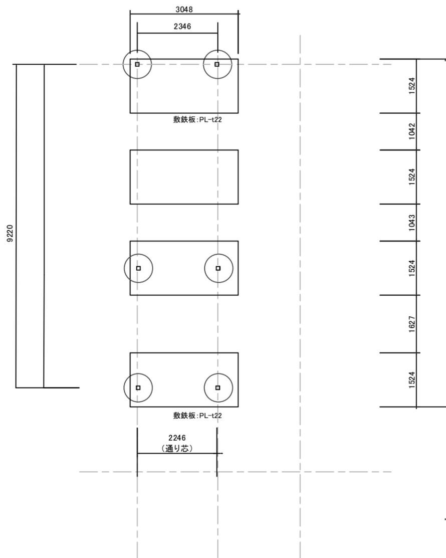
基礎伏図 (見下げ図) ○ -溶接箇所
