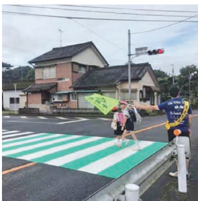
カラー舗装された横断歩道（霧島市）
