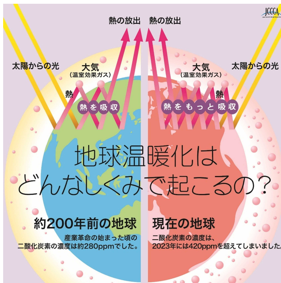
図 1-1 温室効果ガスと地球温暖化のメカニズム
