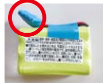
充電式電池(絶縁処理) ※コネクタ部の被覆
